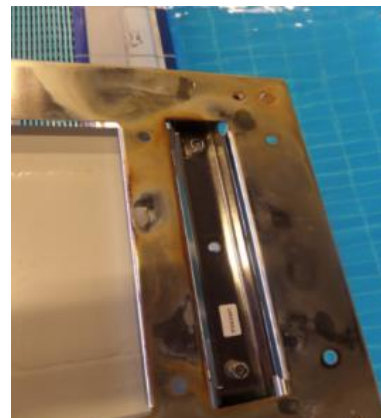
OSB mal entretenu
